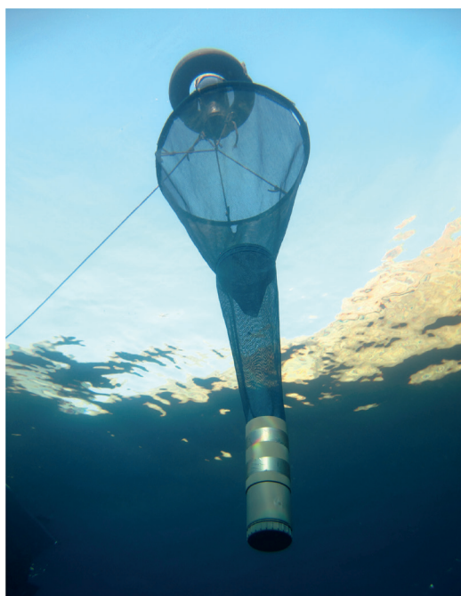
Figure 4. CARE, piège lumineux (©F.C. Félix-hackradt).
