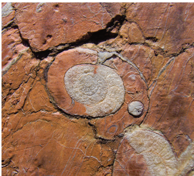
Fig. 2 a et b. Prades (Pyrénées-Orientales), fontaine de la place de la République en marbre griotte, 1867. En a : vue macroscopique des fossiles sur les parties polies, aujourd'hui dégradées par l'altération. En b : détail d'un moule de coquille déformé donnant l'aspect « œil de perdrix ». Longueur maximale, entre deux et trois cm. © Cécile Respaut.
