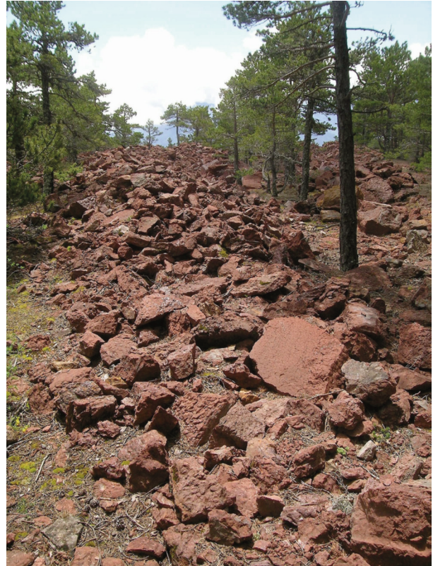
Fig. 19. Serdinya (Pyrénées-Orientales), carrière du Roc Vermeil à Roca fumada ; vue d'une halde encombrée de grands quartiers de marbre rouge griotte débités à l'explosif. © Cécile Respaut.
