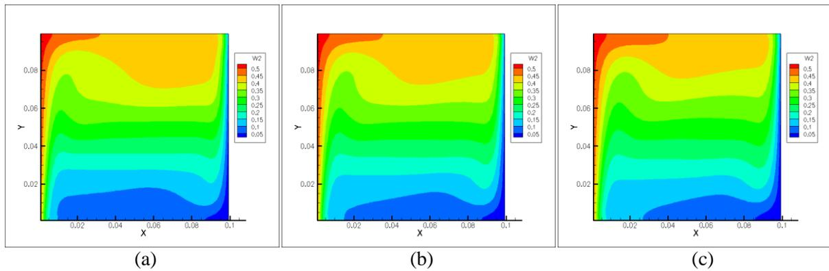
Fig 4: Répartition de la fraction massique à l'intérieur de la cavité pour  $W_0 = -0.5, 0$  et  $+0.5$  respectivement (a), (b) et (c), ( $A=0.1$  ;  $Fr = 0,4225 \cdot 10^{-6}$ ,  $Sc = 0,71$ ;  $\varepsilon_m = 0,3$ ;  $C_W = 1,387$  ou  $M^* = 0,6$ ;  $W_{2,h} = 0,53$  et  $W_{2,c} = 0,0$ )
