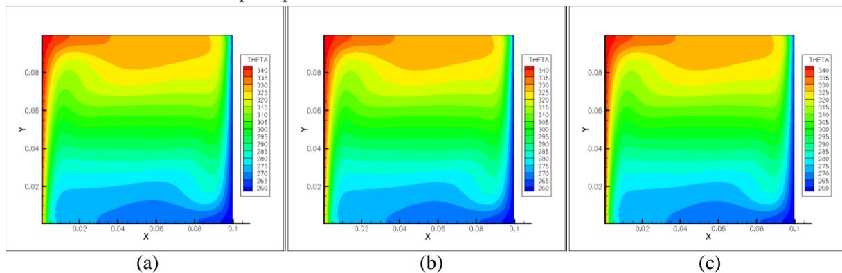
Figure3: Répartition de la température à l'intérieur de la cavité pour  $\theta_0 = -0.5, 0, +0.5$  respectivement (a), (b) et (c). ( $A=0.1, Fr = 0,4225 \cdot 10^{-6}$ ;  $\sigma = 0,71$ ;  $\varepsilon_T = 0,3$ ;  $\gamma = 1,4$ )
