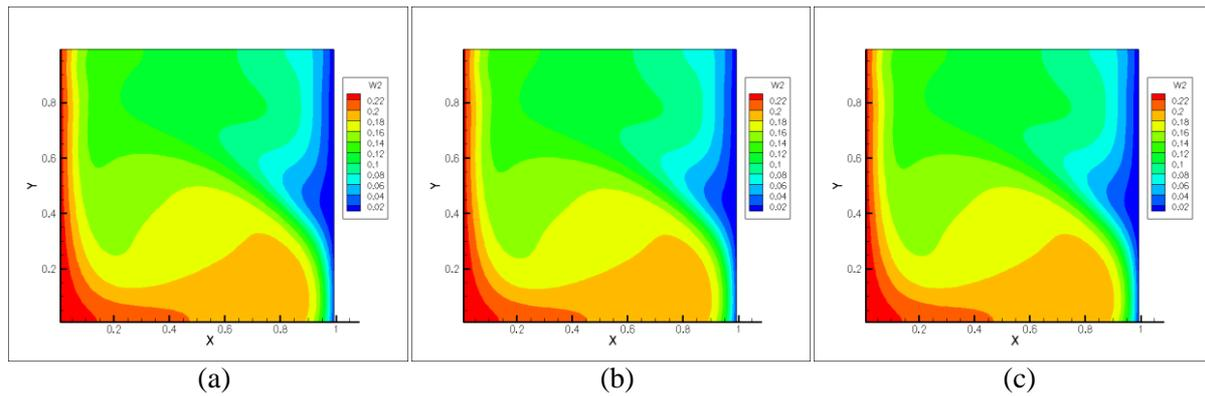
Fig 6 : Iso fraction massique pour les conditions initiales ( $\theta_0 = W_0 = -0,5; 0$  et  $+0,5$ ) respectivement (a), (b) et (c). ( $A=0,1$  ;  $Le=1$  ;  $Fr = 10^{-7}$ ;  $Sc = 0,71$ ;  $\varepsilon_T = 0,2$ ;  $\varepsilon_m = -0,2$ ;  $C_W = 3,6322$  ou  $M^* = 4$ ;  $W_{2,h} = 0,242$  et  $W_{2,c} = 0,0$  )
