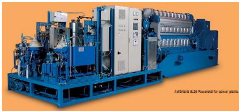
Figure 1.17: Générateur diesel de type Wärtsilä 9L20 Powerskid.
